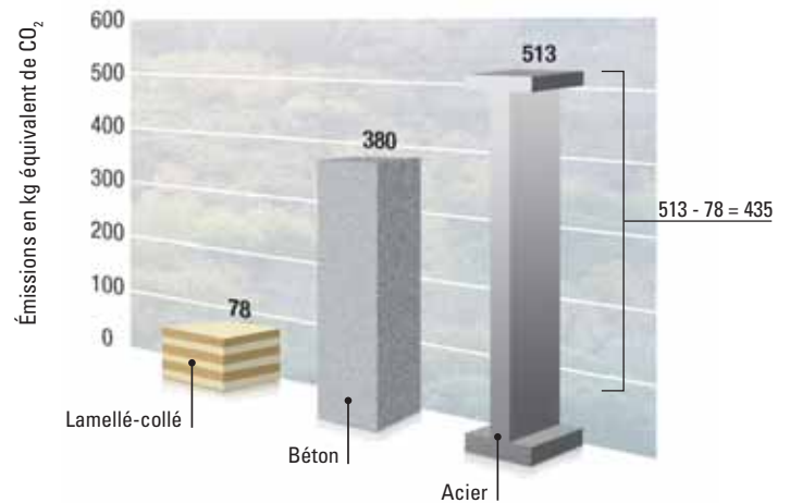
Figure 1 Potentiel de réchauffement climatique d'une poutre de 7,3 m supportant une charge de 14,4 kN/m
